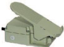
**Fußregler eT:** sehr stabile und robuste Ausführung aus Aludruckguß für den rauen Einsatz. Start/Stopfunktion über Fußregler. 5 Meter Kabel mit Stecker. Leistungsbereich über WIG-Anlage begrenzt.
